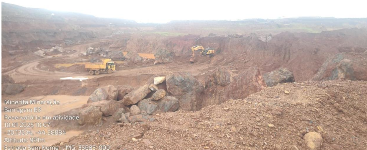
Escavação realizada por conjuntos escavadeiras e caminhões basculantes.
